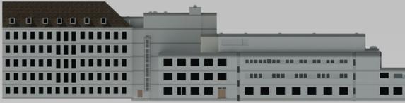
Als Basis für Sanierungs- und Renovierungsmaßnahmen sind Grundrisse, Schnitte und Fassadenpläne eine wertvolle Unterstützung für jeden Planer. Bei einem Gebäudeaufmaß werden je nach Komplexität und Genauigkeit unterschiedliche Messtechnologien eingesetzt. Vom Messband bzw. Laserdistanzmesser über Einzelpunktbestimmungen mittels Tachymeter bis hin zu Laserscannern oder Mobile Mapping Systemen (TIMMS) mit Laserscanner wird jeweils die effizienteste Technologie eingesetzt.
